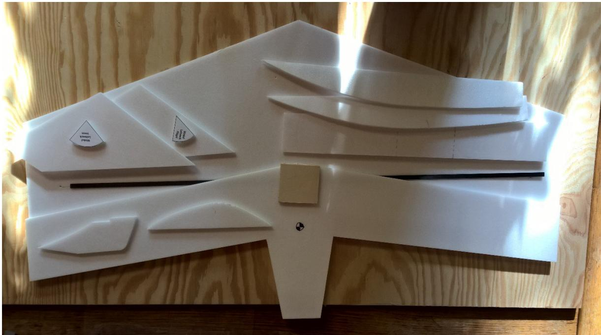
Als erstes wird der Kohlefaser Holm in den ausgeschnittenen Schlitz eingeklebt. Aufpassen, dass der Holm sauber eingepasst ist, und kein Spalt entsteht.
