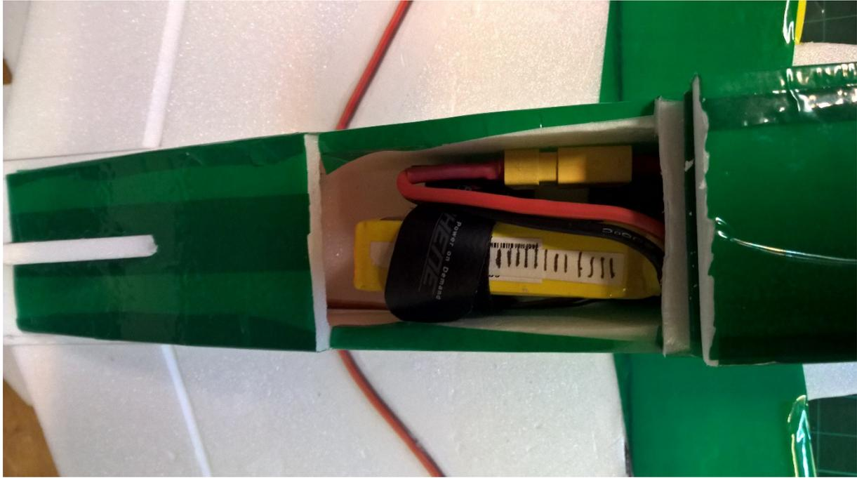
Hier ist noch ein Detail für den Akkueinbau und die Befestigung.
