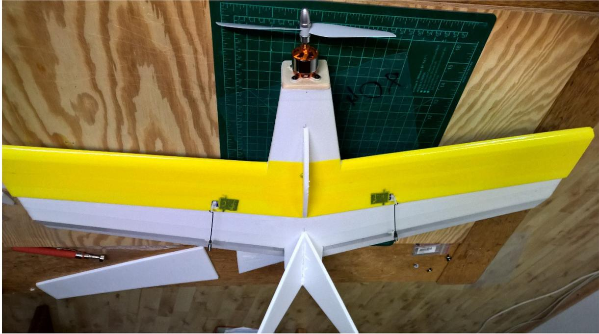
Leitwerk und Haube mit PU-Leim bzw. UHU Por verklebt, der Motor ist montiert.
