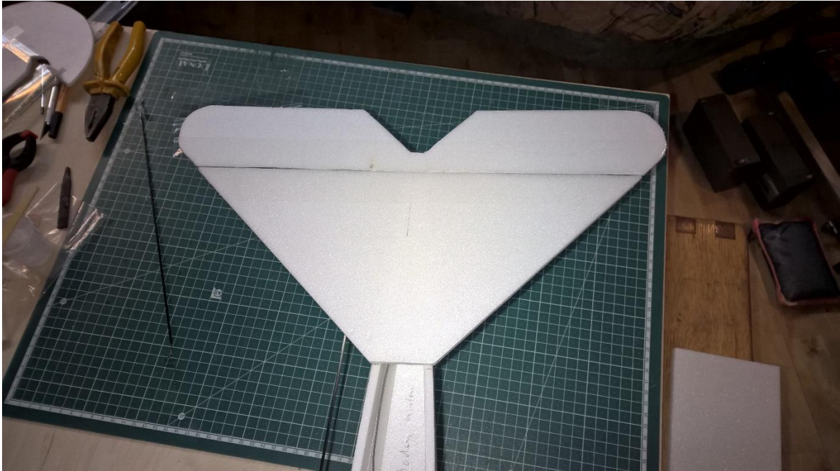
Das Höhenleitwerk wird aufgeklebt und genau ausgerichtet.
