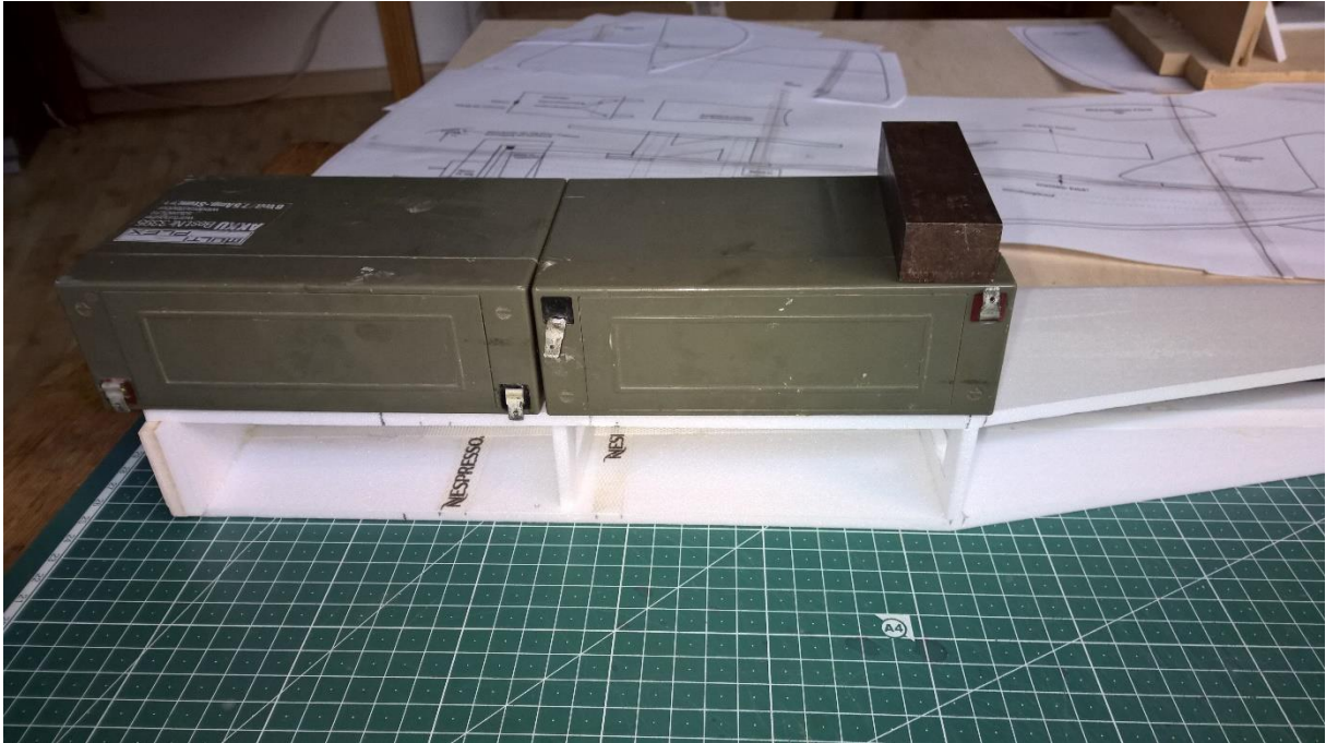
Verkleben von Spant F2. Der Spant in der Mitte ist nur ein Distanzstück während die Verklebung trocknet.
