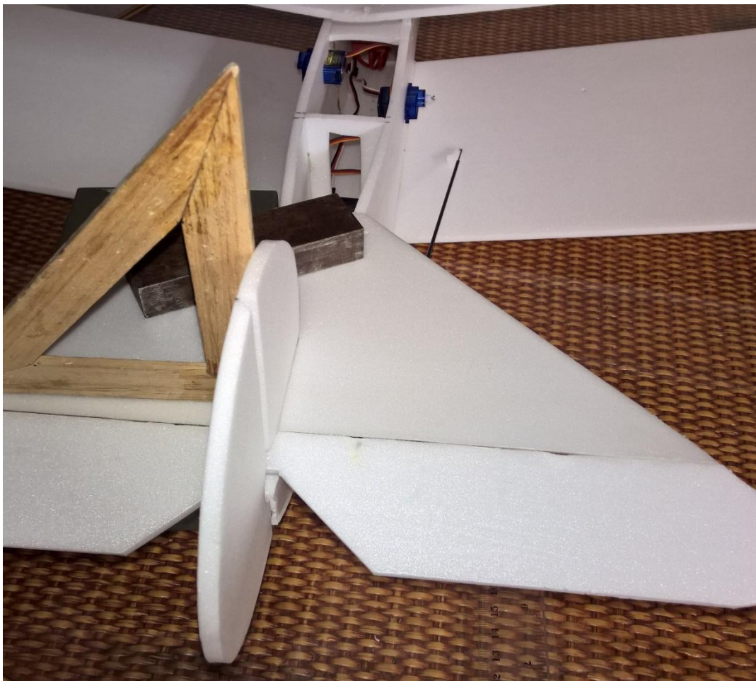
Das Seitenleitwerk wird rechtwinklig auf das Höhenleitwerk aufgeklebt.
